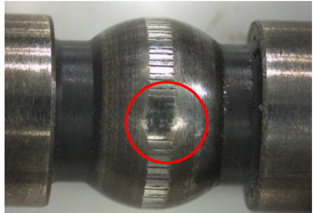
마모된 텐션 그리퍼: 홈이 파인 부분이 일부 마모됨
