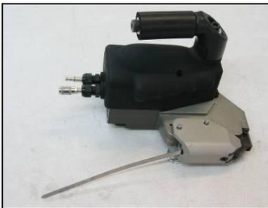
5. クランプが完了したら、クランプテールの切断テールをツールから必ず取り除いてください。切断テールは、自動的に排出されません。取り除いたら、次のクランプの準備が整います。
