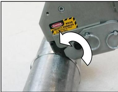
4. クランプを引張る間、ツールをやや前側に傾けるよう保持してください。これで、クランプが正しく装着されます。ツールが完全にクランプを引張り切り、切断するまで、作動トリガーを押し続けます。切断後、トリガーを放します。
