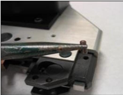
カッターナイフピンを取り外すには、アクセスホール線上にあるカッターナイフピンで示されている一番上の位置にナイフアセンブリーが来ていることが必要です。この位置にきていない場合は、ツールをエアコントロールモジュールに接続します。エア遮断弁を開き、ツールに一瞬圧力をかけます。遮断弁を閉じ、ツールをエアコントロールモジュールから切離します。次に、ワイヤー状のもの(ゼムクリップなど)でカッターナイフピンを押し出します。
