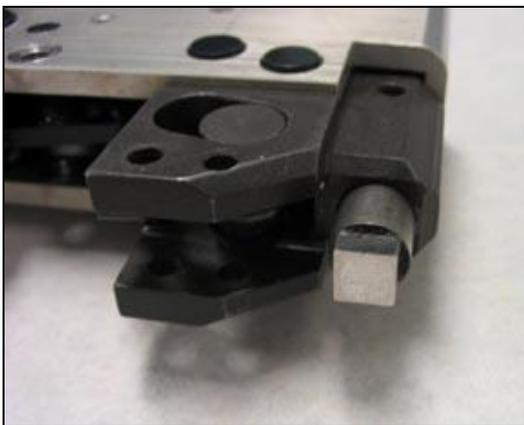
ピンを取り外したら、先細プライヤーを使ってナイフアセンブリーをつかみ、ツールヘッドから引き出します。摩耗を確認し、必要に応じて交換するか、180度回転させます。
