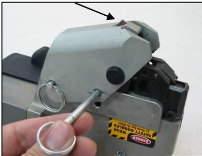
1. フリップカバーの締め付けねじをゆるめ(上の注を参照)、図のようにクイック・リリース・ピンを両方取り外します。
