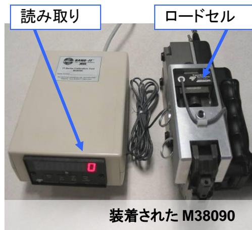
ツールの校正を確認するには、校正デバイスを装着し、エア供給を接続して、トリガーを起動します。ツールが動きを停止したら、表示を読み取ります。M38090 校正デバイスが、データ取得システムで計算された力より 15 lbs (約6.8 kg) 以上異なる場合は、ツールを BAND-IT-IDEX, Inc. に返送し、修理する必要があります。ツールのリセットボタンを押して力を解放し、校正デバイスを取り外します。7 ページに示されているようにツールにカバーを再度取り付け、クイック・リリース・ピンを挿入する前に、メンテナンスカバーがクリーニングされていて、潤滑油が塗布されていることを確認してください。
