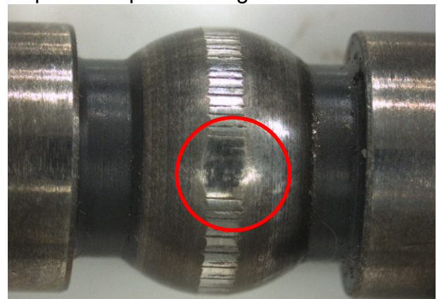
Una pinza de tensión desgastada: Los filos están desgastados en algunas secciones
